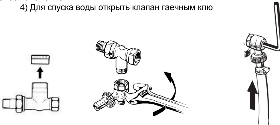
Рис. 3. Монтаж спускного крана.
